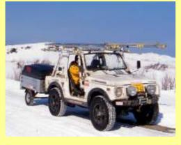
5年間あまりの構想期間を経て1999年製作に着手し、2000年夏に完成したZEVEXの4WD電気自動車1号機。ウインチを搭載して本格的なオフロード走動は現在でも世界でこの1台だけ、全回のプロジェクトでは、量100ccのガソリン発電機2機2元電器を車載してプラグインバリッド化して使用する。
